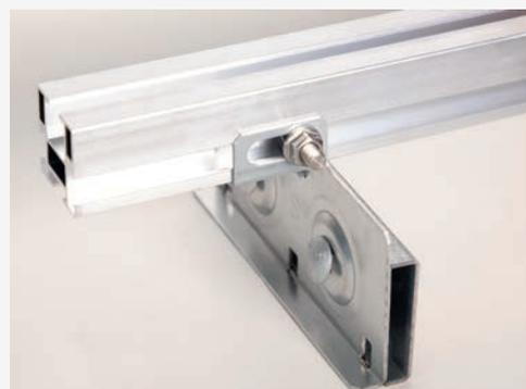
Justera höjden på takfotens motpart till rätt höjd enligt takfogen och dra åt skruvarna. Dra inte åt skruvarna för hårt så att takfoten inte pressas samman vid skruvarna.
