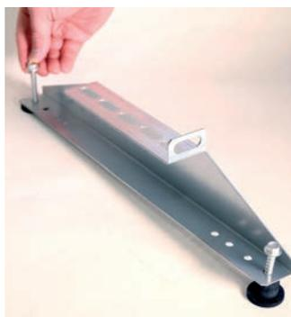
Skruva fast takfoten i läkten. Placera profilskenan över takfoten och sätt in hammarbultarna genom takfoten i profilskenan. Dra åt med en mutter.
