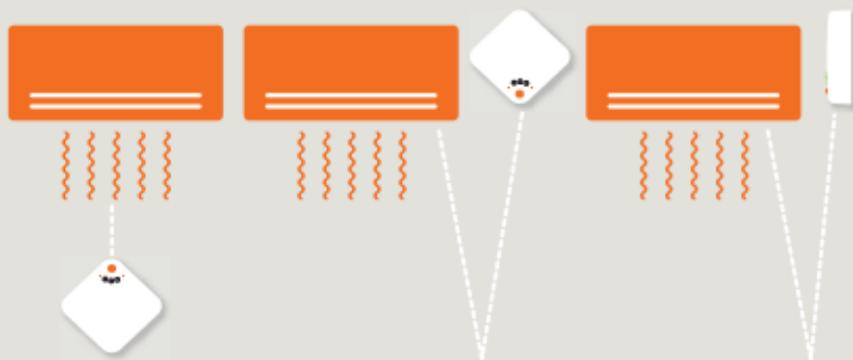
Myös muut kiinnitystavat ovat mahdollisia edellyttäen, että infrapunasäteen yhteys ohjaimesta pumppuun toimii.
