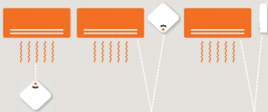
Andre monteringskonfigurationer er mulige for så længe IR transmission fra kontrolleren til pumpen virker.
