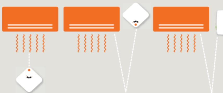
Andra monteringsätt är tillåtna, förutsatt att IR-överföringen mellan AirPatrol Nordic och värmepumpen fungerar.
